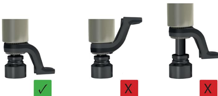
No coloque el equipo ladeado, por ejemplo, en espacios reducidos. Existe un riesgo de rotura, el vaso de impacto puede romperse y el equipo dañarse.
