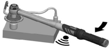
Ahora ajuste el torquímetro al máximo torque permitido. Ajuste el disco de grados al ángulo deseado.
