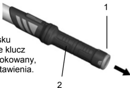
Obrócić uchwyt (2), aż żądana wartość momentu obrotowego danej podziałki (3) N·m lub lbf·ft / lbf·in pokryje się z oznaczeniem na lupie.
