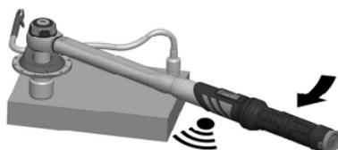
现在将扭矩扳手设定在最大许可扭矩。将角度轮设定在所需角度。
