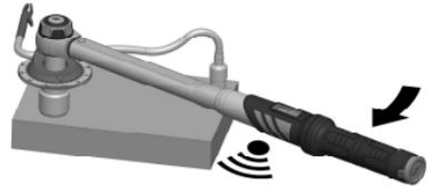
Réglez maintenant la clé dynamométrique à la valeur de couple maximale permise. Réglez le disque selon le degré d'angle voulu.
