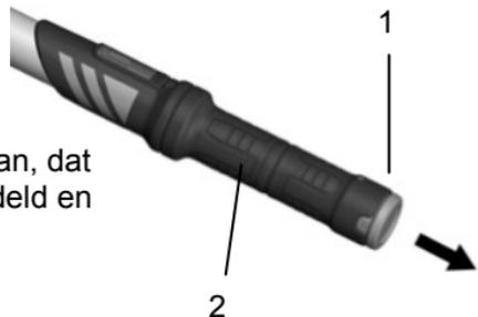
Draai het handvat (2) totdat het gewenste draaimoment van de desbetreffende schaal (3) N·m of lbf·ft / lbf·in overeenkomt met de markering op de loep.
