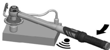
Настройте динамометрический резьбовозавинчивающий инструмент на его максимальный крутящий момент. Настройте градуировочный диск на требуемый угол.
