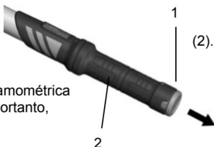
Rodar o punho (2), até que o binário desejado da respectiva escala (3) Nm ou lbf ft/lbf in coincida com a marcação na lupa.
