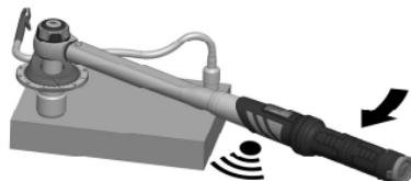
Настройте динамометрический резьбозавинчивающий инструмент на его максимальный крутящий момент.
