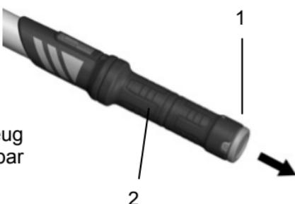
Griff (2) drehen, bis der gewünschte Drehmomentwert der jeweiligen Skala (3) N·m oder lbf·ft / lbf·in mit der Markierung auf der Lupe übereinstimmt.
