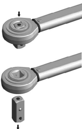
резьбозавинчивающий инструмент и вновь вставить соединительный четырехгранный хвостовик.
