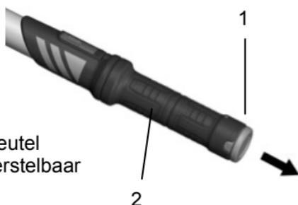
Draai het handvat (2) totdat het gewenste draaimoment van de desbetreffende schaal (3) Nm of lbf-ft / lbf-in overeenkomt met de markering op de loep.
