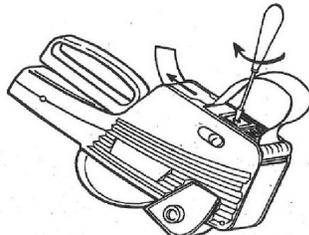
ENROSCAR EL TORNILLO DEL CENTRO DE LA BASE APLOJANDO EL TORNILLO. REGULAR Y FIJAR EL TORNILLO.
