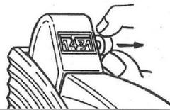
TIRAR LA MANECILLA AL LADO DEL CABEZALE. COLOCAR EL INDICADOR SOBRE LA BANDA A CAMBIAR. REPETIR LA OPERACION PARA SELECCIONAR LAS CIFRAS SUCESIVAS. COLOCAR LA MANECILLA EN LA POSICION ORIGINAL.
