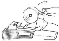
ABRIR LA TAPA SUPERIOR HACIENDO UNA LIGERA PRESION HACIA HARRIBA. DESENVOLVER APROXIMADAMENTE 20 CM. DEL ROLLO DE ETIQUETAS Y INTRODUCIRLO EN EL INTERIOR DE LA MAQUINA, EN LA FISURA ADAPTADA.
