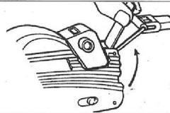
EMPUJAR LIGERAMENTE A LOS LADOS DE LA TAPA PROTECTORA. LLEVARLO HACIA HARRIBA JUNTO AL EXTRACTOR. SOSTITUIR EL RODILLO HACIENDO UNA LIGERA PRESION HACIA ABAJO. INTRODUCIR EL NUEVO RODILLO EN EL EXTRACTOR E INTRODUCIRLO EN LAS GUIAS ASEGURANDOSE QUE ESTE BLOQUEADO.
