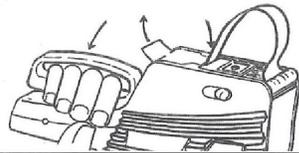
PONER LA EXTREMIDAD DEL ROLLO EN LA PANURA ENTRE EL ROLLO DE APLAZAMIENTO Y EL DE ARRASTRE. APRETAR EL MANGO DE LA MÁQUINA HASTA APAREZCA LA PRIMERA ETIQUETA IMPRESA DE FORMA CORRECTA.
