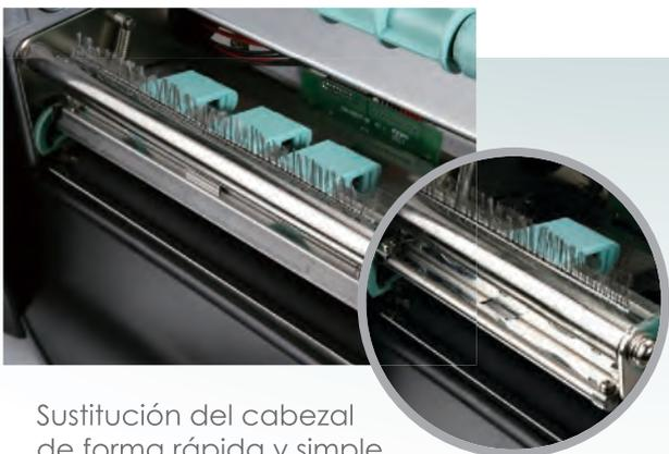
Sustitución del cabezal
