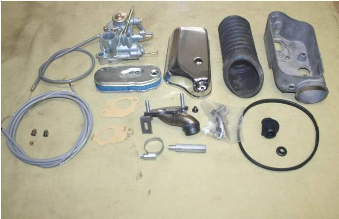
Primero de todo desmontar el antiguo filtro de aire y carburador del cilindro. Hay que suprimir la oreja que sobresale del cárter motor donde se sujetaba el antiguo filtro del aire ya que molesta para colocar la nueva caja de filtro del kit comprado, se puede cortar con una hoja de sierra o con la mola de disco. Montar el distanciador del amortiguador trasero para separar el motor del chasis y lograr el espacio para poder montar todo el conjunto.
