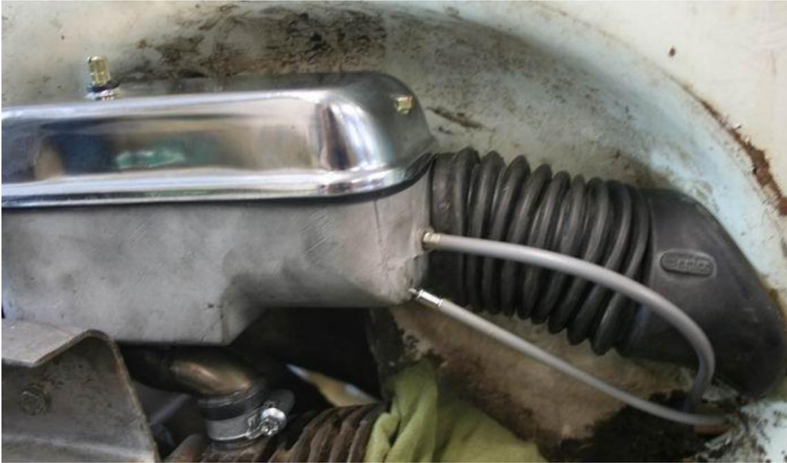
Colocar el tubo de la gasolina, cable del estárter, cable de gas y filtro de aire. En este momento se puede probar que la vespa arranque y funcione bien, puede que el chicle suministrado no sea el adecuado, pero esto depende de cada vespa y la altitud respecto al mar de cada usuario. Colocar la tapa del filtro, el tornillo del ralentí y el fuelle hasta el chasis.
