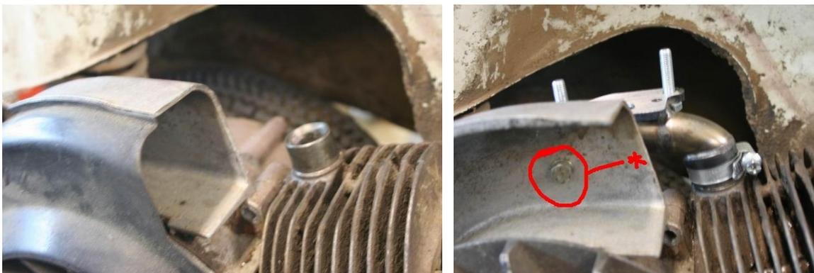
Montar el nuevo colector con la junta torica montada en su interior y hacer taladro en la pared del cárter para sujetar el nuevo conjunto de colector/carburador. Se monta la junta entre caja y colector (suministrada en el kit) se puede untar con grasa para ablandarla y que asiente bien. Se sujeta la caja de filtro y colocar la junta entre el carburador y la caja también con un poco de grasa. Se sujeta el carburador con los tornillos suministrados con el kit de carburación.
